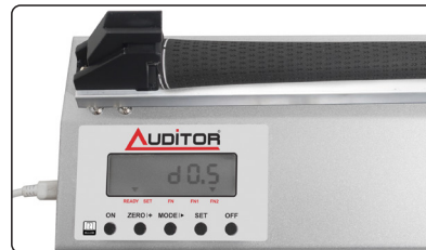
▲0.5 SW 단위 표시, 클럽 총 중량 및 구성품 1g 단위 측정
